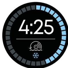
Der Degritter verwendet 300 W Strom für die Ultraschallreinigung. Das meiste davon wird schließlich in Wärme umgewandelt, die die Wassertemperatur im Ultraschallreinigungstank langsam erhöht. Sobald die Wassertemperatur 35 °C (95 °F) erreicht, verlängert das Gerät das Waschprogramm um einen 3-minütigen Wasserkühlungszyklus. Dies soll verhindern, dass die Schallplatte durch zu hohe Temperaturen
