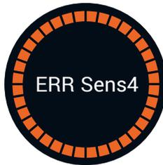
Die Warnungen ERR Sens4 oder ERR Sens5 zeigen an, dass das Gerät den oberen Wasserstand im Ultraschallreinigungstank nicht richtig erkannt hat.
