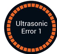
Diese Warnung zeigt an, dass die Verbindung zwischen der Steuerplatine des Geräts und dem Ultraschallgenerator ausgefallen ist.
