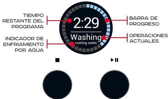
Durante el lavado ultrasónico, la máquina mostrará la lectura de la temperatura del agua de su tanque de limpieza ultrasónica. La unidad de temperatura se puede cambiar entre Celsius y Fahrenheit en la sección Info.
