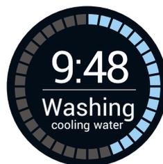
La máquina Degritter está utilizando 300 W de potencia para su limpieza ultrasónica. Gran parte se convertirá eventualmente en calor que elevará lentamente la temperatura del agua en el tanque de limpieza ultrasónica. Una vez que la temperatura del agua alcanza los 35 °C, la máquina insertará un ciclo de enfriamiento por agua de 3 minutos en el programa de lavado. Esto sirve para evitar que el disco
