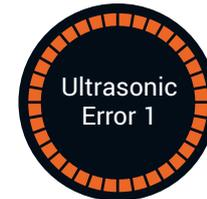
La advertencia indica que la conexión entre la placa de control de la máquina y el generador ultrasónico ha fallado. Reinicie la unidad manualmente desde el panel trasero, espere 10 segundos y vuelva a encender la máquina. Si el problema persiste, póngase en contacto con [support@degritter.com](mailto:support@degritter.com) para obtener ayuda.
