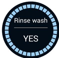
Cuando la opción de lavado de enjuague está habilitada, la máquina intentará usar un tanque de agua separado para enjuagar los discos después de cada ciclo de lavado. Para hacerlo, el usuario debe tener dos tanques de agua.
