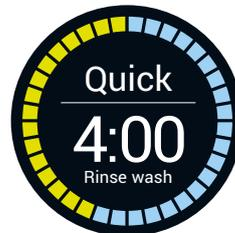
Wenn die Option „RINSE“ aktiviert ist, versucht das Gerät, nach jedem Waschgang einen separaten Wassertank zum Spülen der Platten zu verwenden. Dazu muss der Benutzer über zwei Wassertanks verfügen.
