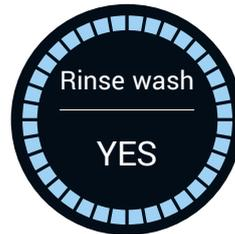
Nachspülen. Die Einstellung „RINSE“ aktiviert oder deaktiviert die Schallplattenspülfunktion. Wenn das Nachspülen eingeschaltet ist, wird bei den Programmen unter der Programmzeit der kleine Text „RINSE“ angezeigt.
