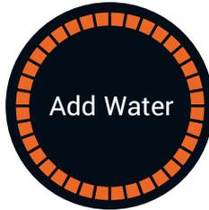
Die Warnung „Add Water“ (Wasser nachfüllen) wird angezeigt, wenn der abnehmbare Wassertank nicht mehr ausreicht, um den Ultraschallreinigungstank zu füllen. Während des Waschens und Trocknens verdunstet Wasser und der Wassertank muss aufgefüllt werden.
