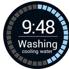
Der Degritter verwendet 300 W Strom für die Ultraschallreinigung. Das meiste davon wird schließlich in Wärme umgewandelt, die die Wassertemperatur im Ultraschallreinigungstank langsam erhöht. Sobald die Wassertemperatur 35 °C (95 °F) erreicht, verlängert das Gerät das Waschprogramm um einen 3-minütigen Wasserkühlungszyklus. Dies soll verhindern, dass die Schallplatte durch zu hohe Temperaturen beschädigt wird.
