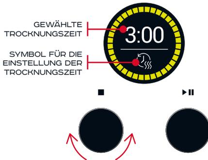
Waschgangs können Sie damit allerdings nicht ändern. Sie können die Trocknungszeit ebenfalls im Reinigungsprogramm einstellen, während die Schallplatte getrocknet wird.
