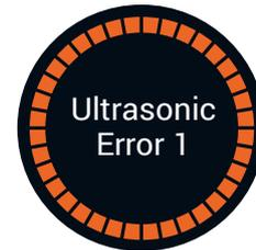
Diese Warnung zeigt an, dass die Verbindung zwischen der Steuerplatine des Geräts und dem Ultraschallgenerator ausgefallen ist.
