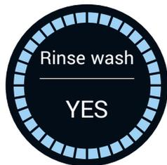
如啟用沖洗選項，機器將在每個清洗週期後使用另外設置的盛水盆對黑膠唱片進行沖洗。為此，使用者必須準備兩個盛水盆。
