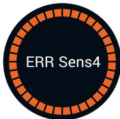
出現警告ERR Sens4或ERR Sens5表示機器未能正確檢測超聲波清洗槽中的上水位。
