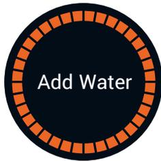
當可移除水盆中的水不足以注滿超聲波清洗箱時，會顯示加水警告。水會在清洗和烘乾過程中蒸發，需要向水盆再添加水。
